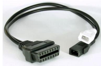
Für die Fahrzeugdiagnose ist es notwendig, das Interface mit dem Fahrzeug zu verbinden. Stecken Sie es dazu einfach in die OBD-2 Buchse im Fahrzeug. Die Buchse finden Sie stets im Innenraum. Bei älteren Modellen kann es noch eine VAG 2x2 Buchse im Motorraum geben, für die es Adapterkabel gibt. Die rote LED im Diagnoseinterface leuchtet nun und zeigt an, daß das Interface mit Spannung versorgt wird.
