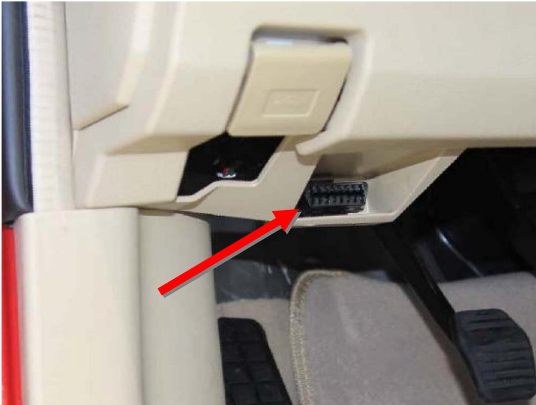
Die Buchse sollte sich im Umkreis von einem Meter um den Fahrersitz im Innenraum herum befinden. Häufig ist sie hinter einer Abdeckung zu finden. Gängige Einbauorte sind der Sicherungskasten, hinter dem Aschenbechereinsatz, über den Fußpedalen, in der Mittelkonsole oder hinter eine Blindblende am Armaturenbrett.
